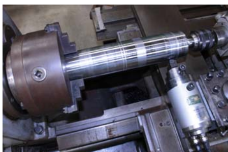
高速精密旋盤と工具動力計による切削抵抗力の計測
