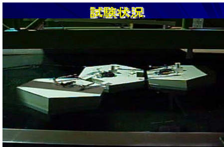
多連結浮体システムの水槽試験の様子
