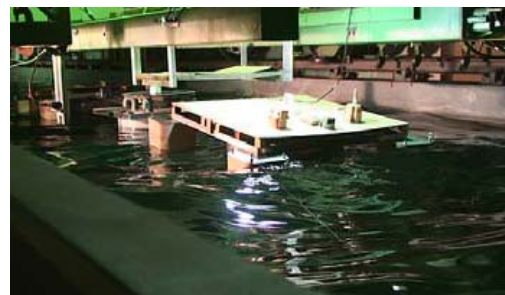
多連結浮体システムの水槽試験の様子
